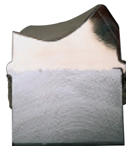
QUERSCHNITT DES ELEKTRONEN- STRAHLGESCHWEIßTEN ZAHNKRANZES UND GRUNDKÖRPER, ZUR VERANSCHAULICHUNG DER VERBINDUNG DES BRONZEKRANZES MIT DEM GUSSEISERNEN GRUNDKÖRPER. DIESE LEISTUNGSSTARKE VERBINDUNG ERMÖGLICHT KRAFTÜBERTRAGUNGEN UNTER STOßBELASTUNGEN.
